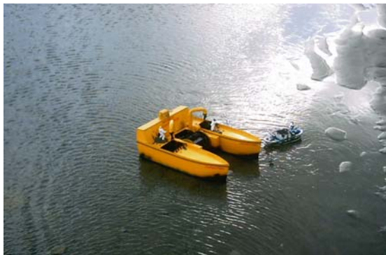
Figura 1.Recreación catamarán con chapapotera entre los dos cascos.
